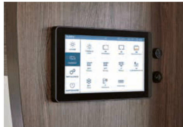
BETJENINGSPANEL TIL STYRING AF INTEGRERET TEKNIK
