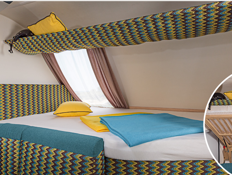
SPORT&FUN 480 QL. Med gasfjedrene kan du nemt klappe den tværvendte seng op, der er standard, og derved let få adgang til opbevaringspladsen under den i fronten.
