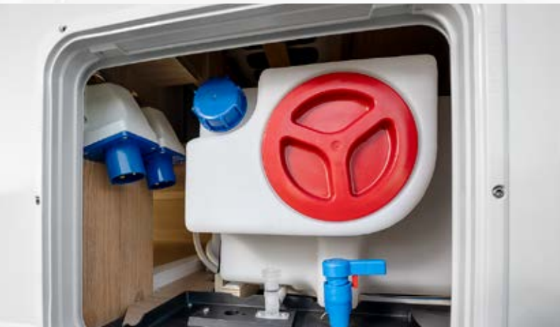
Vand, spildevand og strøm samlet i ét servicemodul
